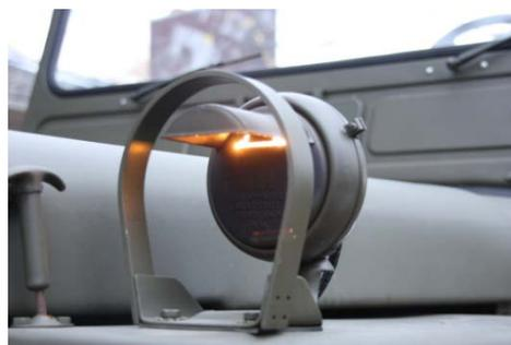
O Farol de Aproximação (*também conhecido por "Farol de Escurecimento" ou "Farol de Blackout"*) é projetado para fornecer uma luz branca de 2,7 a 5,4 lux (*25 a 50 candelas*) a uma distância de 3 metros (*10 pés*) medidos diretamente a partir da frente do veículo.
